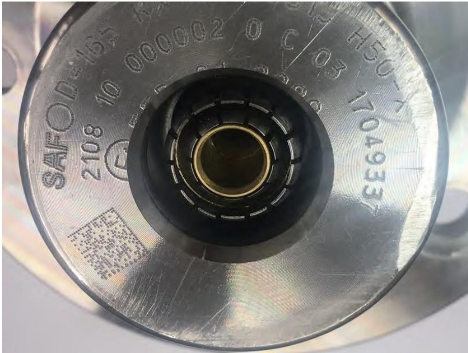
Ansicht des gebohrten Achsschenkelbolzens von oben mit dem Aucos-Verbinder im Inneren.
